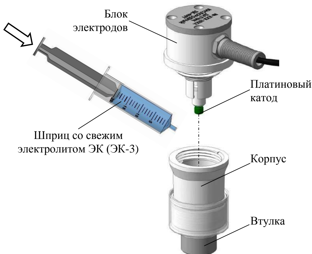
Рисунок 2.7 – Заливка электролита в датчик ДК-409Т, ДК-409ТМ
